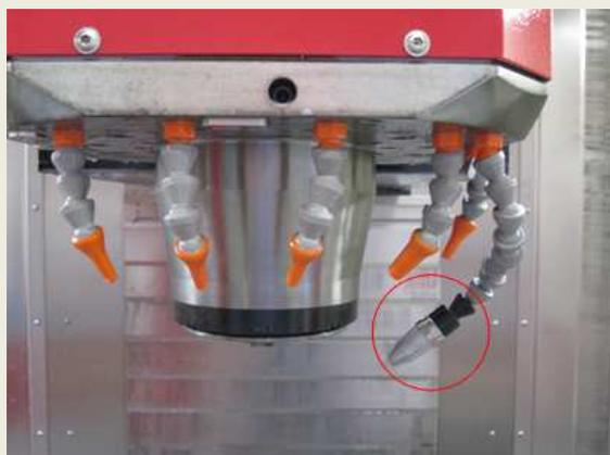
Um Druckluftressourcen einzusparen und die Produktivität zu steigern, hat die Hedelius Maschinenfabrik GmbH swepro beauftragt den offenen Rohrstutzen des Ariana-Gelenkschlauchs, der für das Abblasen der Fertigungsmaschine verantwortlich ist, durch eine effektive Blasdüse zu ersetzen. So hat swepro den Schlauch mit einem Adapter und einer Silvent-Blasdüse versehen. Damit konnte swepro den Lärmpegel und die Energiekosten reduzieren, da die neue Blasdüse nur eine geringe Menge Druckluft als
